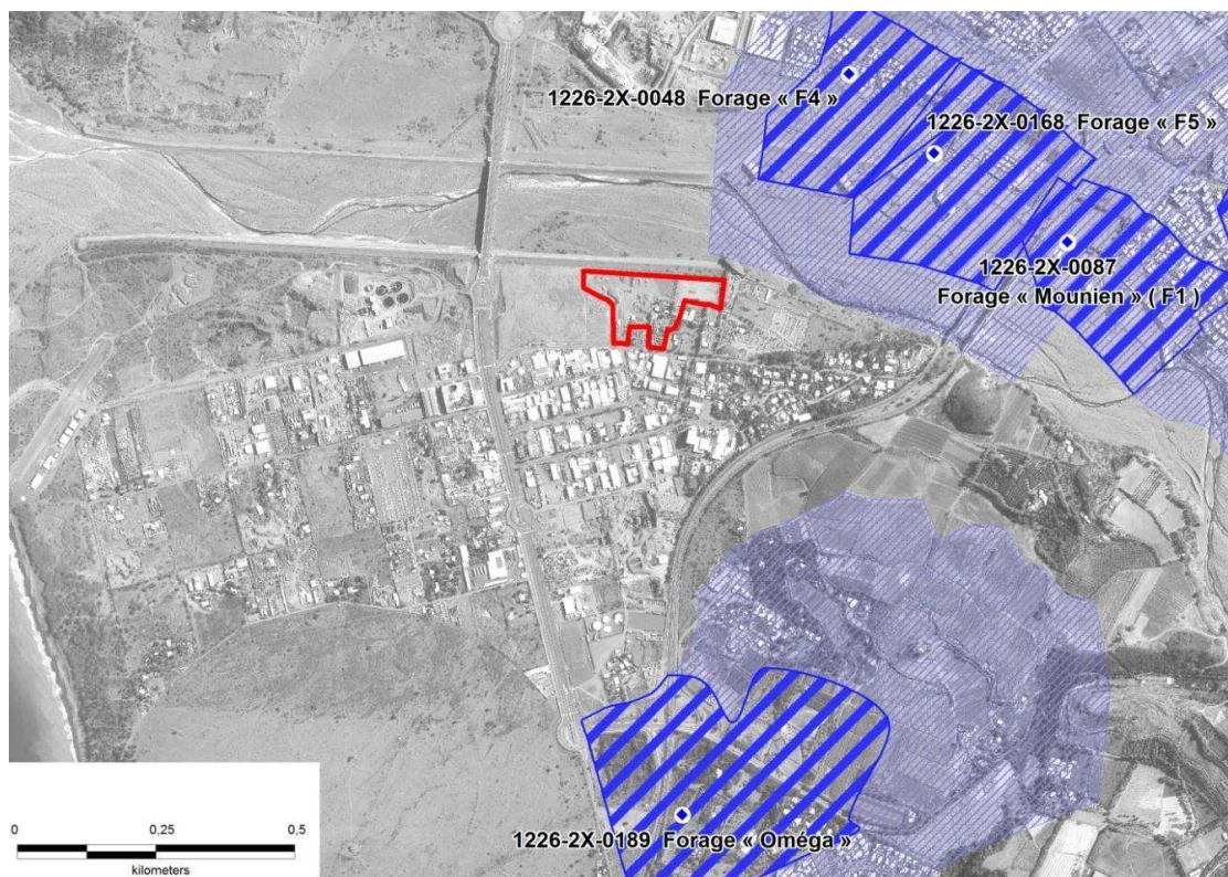
Localisation des forages et captages pour l'alimentation en eau potable à proximité des installations de VALORUN
