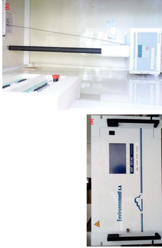
Figure 4 : Analyseur MP 101 M installé dans les remorques laboratoires implantées sur les sites 1 et 5 et analyseur BAM 1020 installé dans la station JOI (Crédits photos : ©Atmo Réunion).
