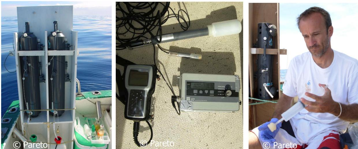
Figure 7 : bouteilles à prélèvements Niskin et analyseur multiparamètres de terrain YSI (©Pareto)
