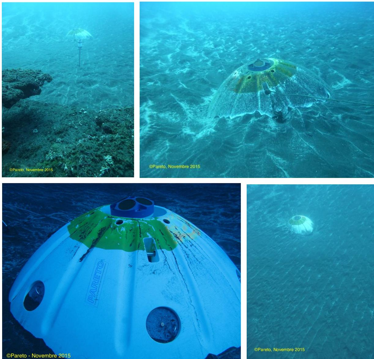
Figure 10 : courantomètre ADCP posé sur le substrat sableux (station 2)(©Pareto)
