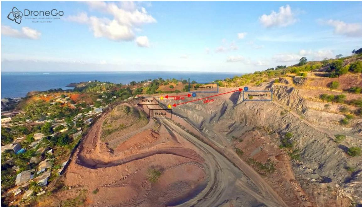
Figure 4 : configuration de la carrière de Koungou et emplacements de chaque tir de mines. Emplacements de sismographe (source ETPC)
