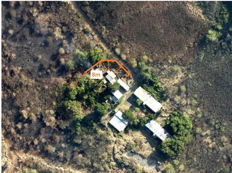
Vue 16 : Schéma de l'emprise général des murs écran de 2,50m
