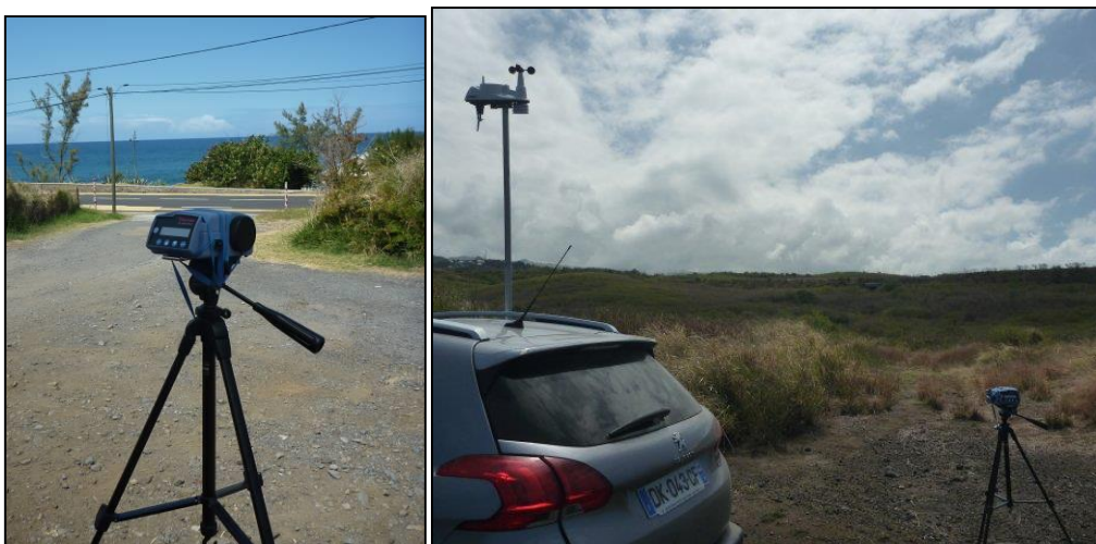
Figure 6: Analyseur de poussières Thermo pDR 1500
