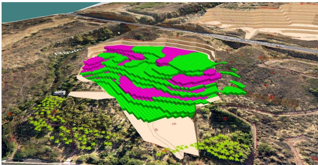
Modèle géologique 3D intégré dans la fosse basse niveau 50 m NGR (rose = basalte sain, vert = basalte altéré) – CORALIS 2015
