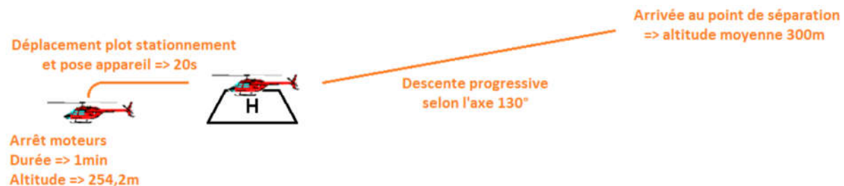
Figure 23. Décomposition d'un atterrissage usuel
