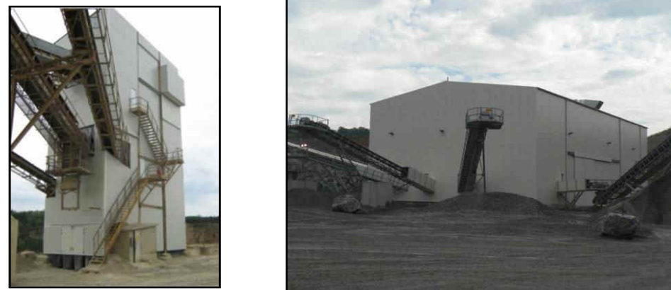
Planche 27 : Exemples d'encoffrements sur concasseur primaire et cribles
