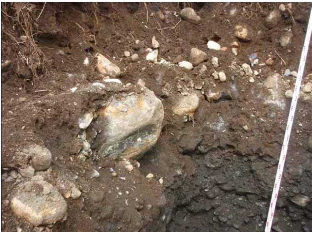
Fig.4 : exemple de sondage à la pelle mécanique
