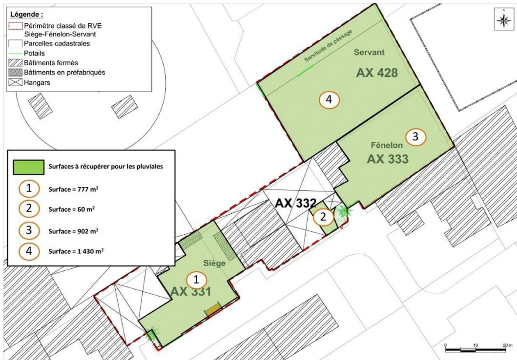
Les eaux « sales » seront stockées et traitées avant rejet vers le canal intercepteur central, les eaux de toitures sont rejetées dans le réseau présent dans le chemin grand canal au sud de la zone.
