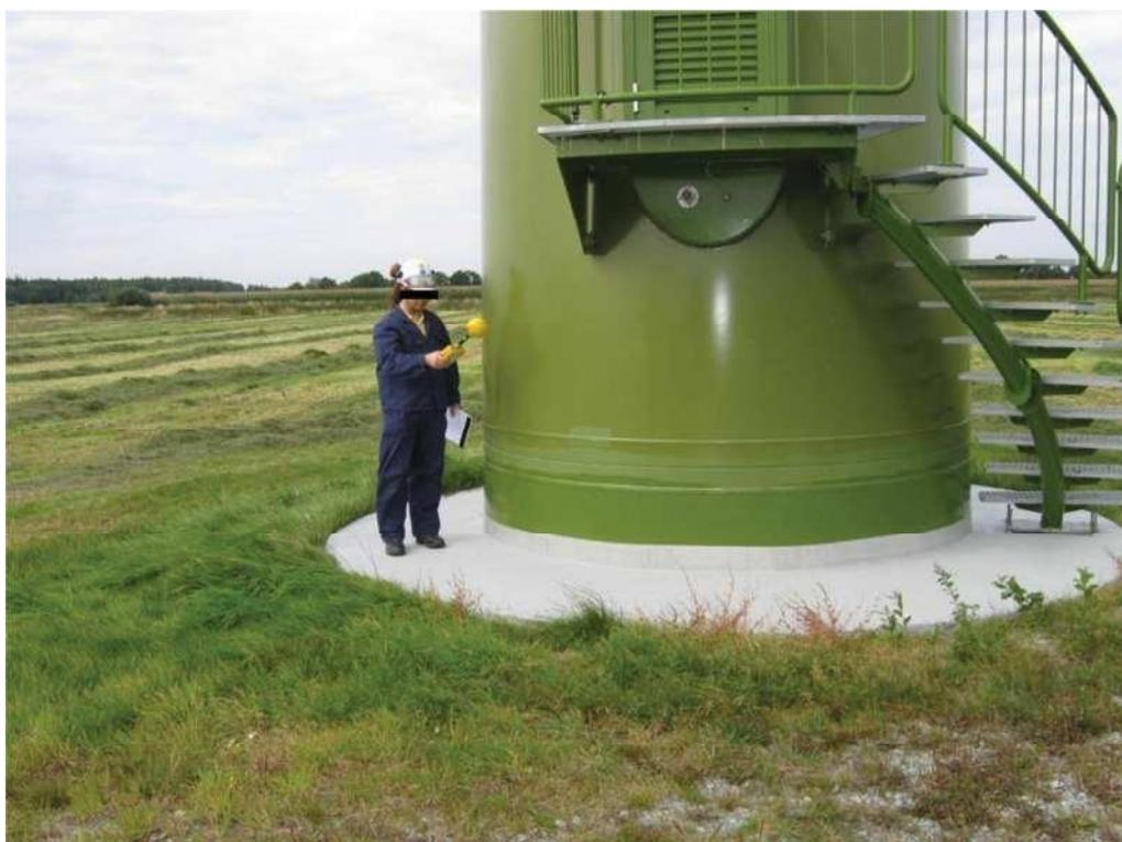
Fig. 1: Mesure de champ magnétique sur la E-53
