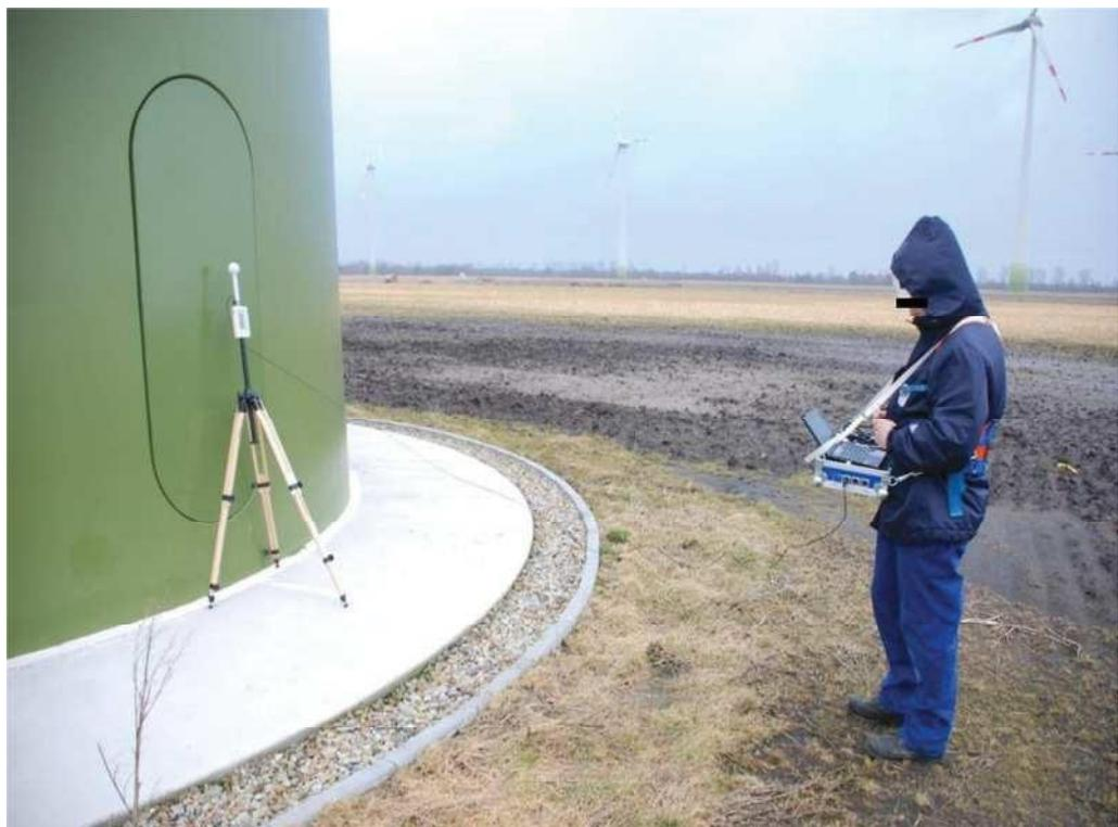
Fig. 3: Mesure de champ magnétique sur la E-101 (avec un autre capteur)
