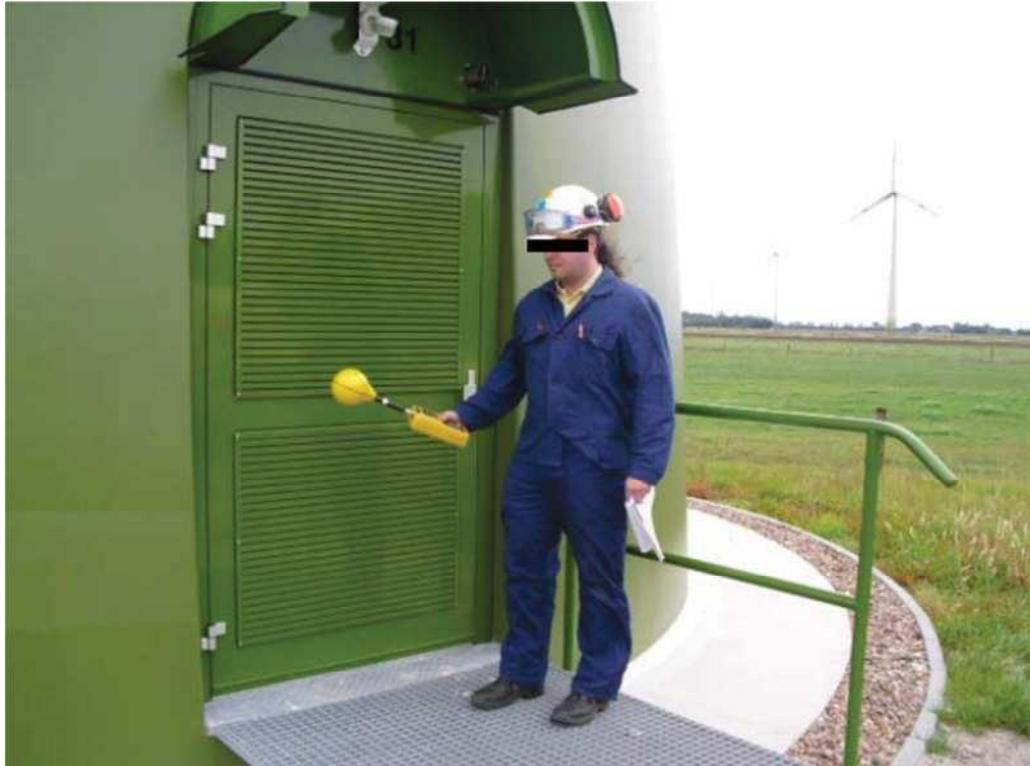
Fig. 2: Mesure de champ magnétique sur la E-82 E2
