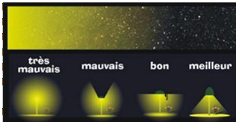
Planche 127 : Orientation des faisceaux lumineux à favoriser et à éviter en cas d'utilisation d'éclairage sur le projet
