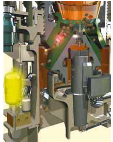
Système de protection contre les imbroyables
