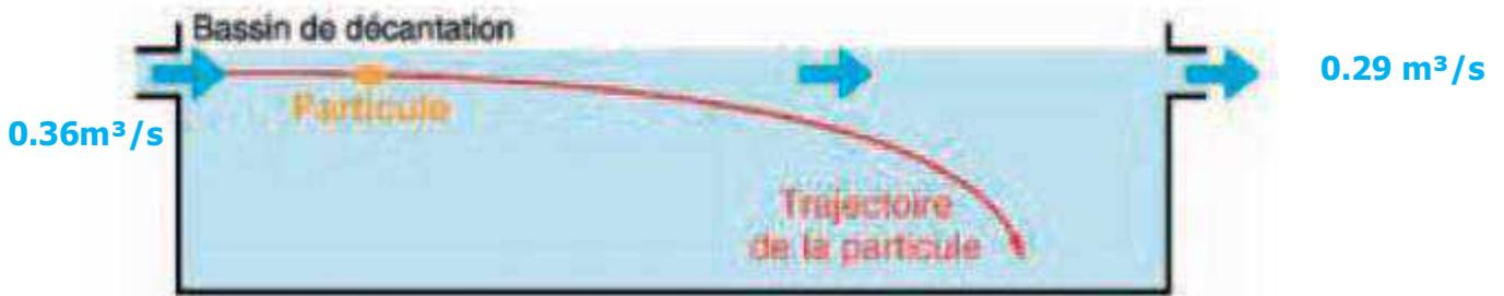
Figure 6 : schéma de principe d'un bassin de rétention / décantation (« Guide sur les modalités de gestion des eaux pluviales à la Réunion », DEAL, 2012)
