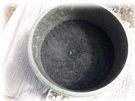
Le moule et son contenu sont alors disposés sur un matériau drainant (en l'occurrence des matériaux non compactés), un géotextile étant positionné à l'interface cendres volantes / matériaux drainants.
