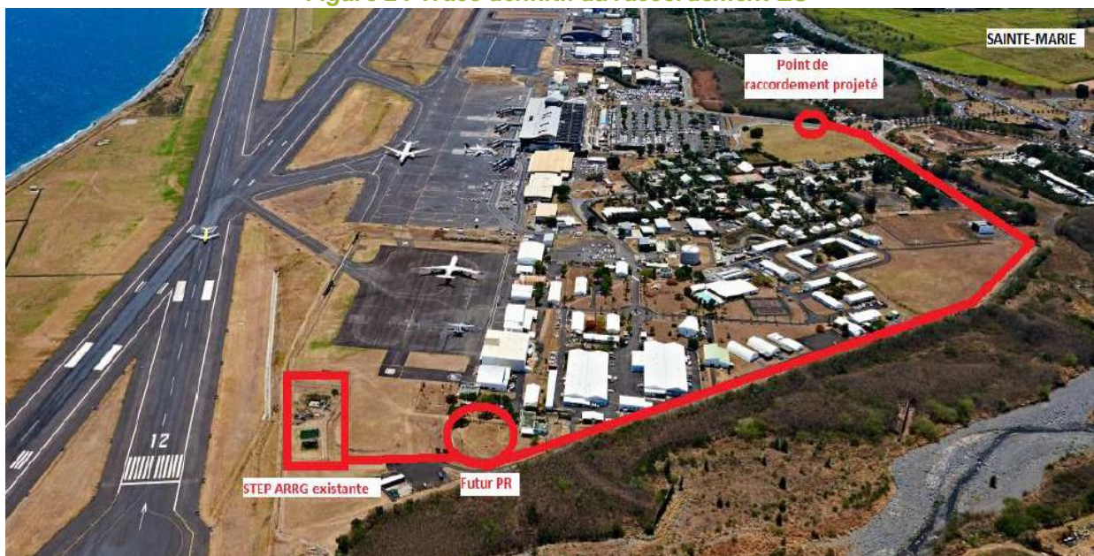
Figure 2 : Tracé définitif du raccordement EU
