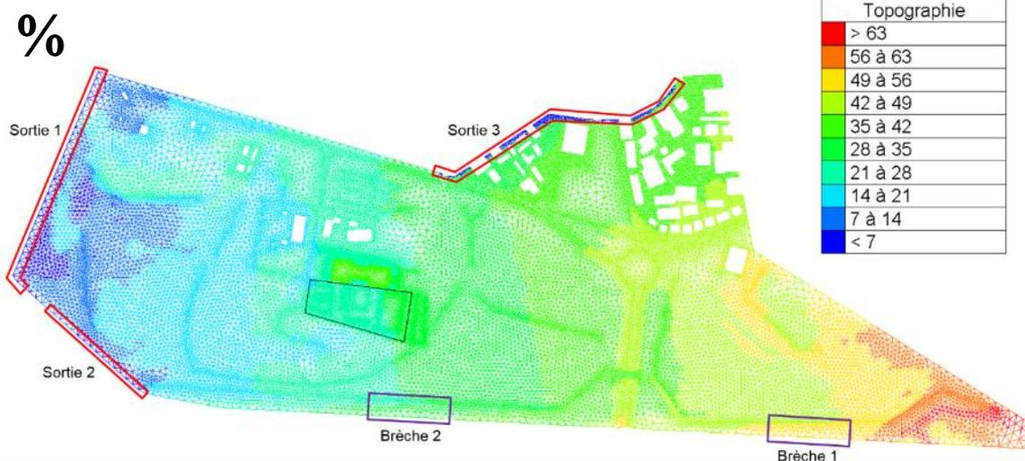
Figure 2 : Topographie de la zone d'étude et définition des conditions aux limites
