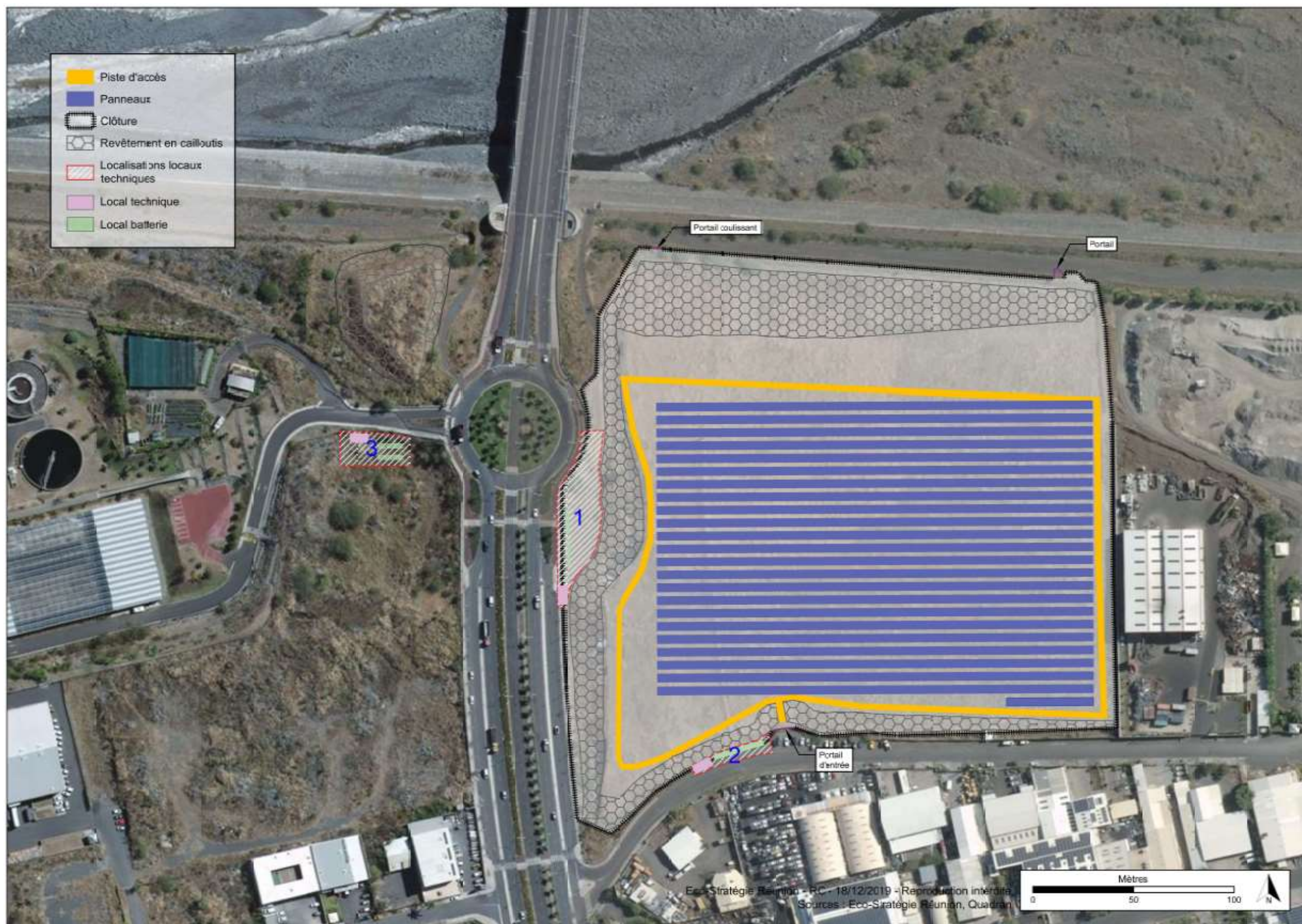
Figure 17 : Caractéristiques techniques du projet présentant les trois variantes d'implantation des locaux techniques. L'emplacement définitif sera défini dans le cadre du traitement paysager avec le GIP EcoCité et en lien avec le PPA EcoCité (Source : ESR à partir des données de TOTAL QUADRAN)
