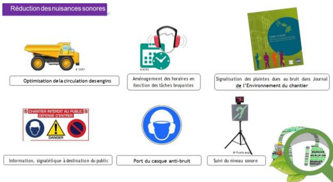
Figure 121 : Exemples de mesures limitant les nuisances sonores en phase chantier
