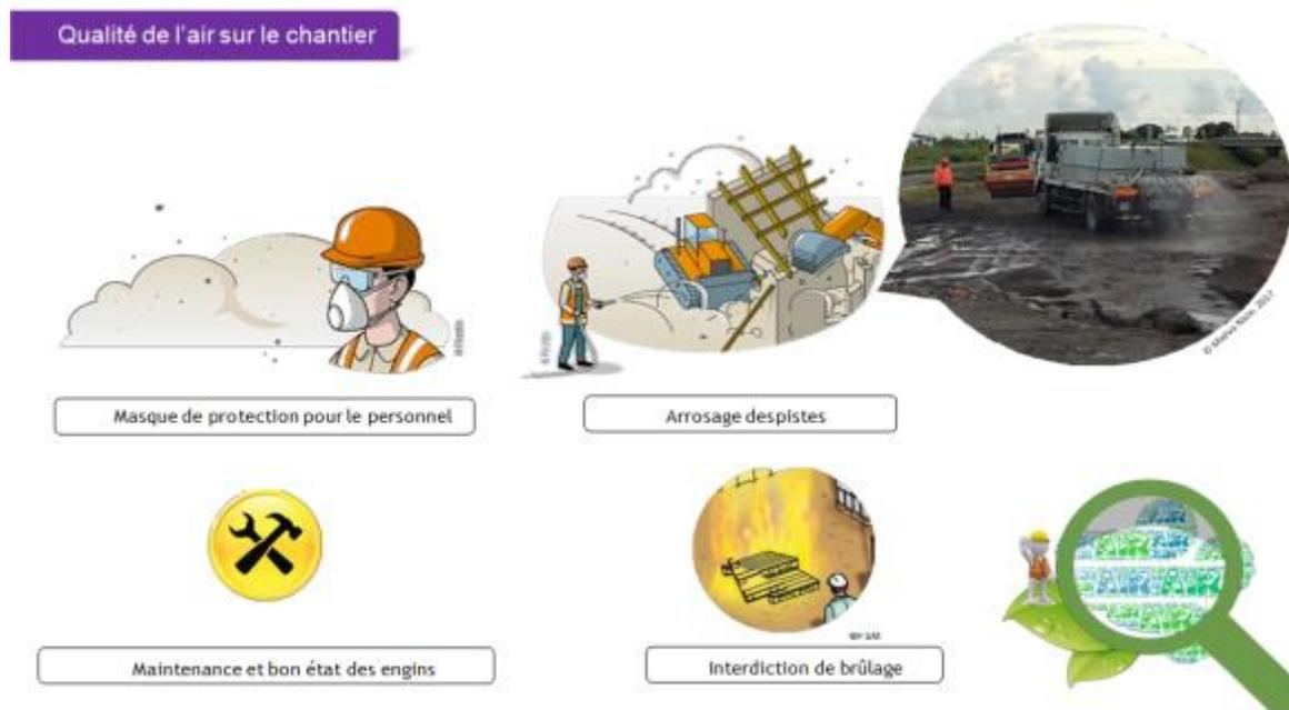
Figure 118 : Exemples de mesures pour limiter l'impact de la phase travaux sur la qualité de l'air
