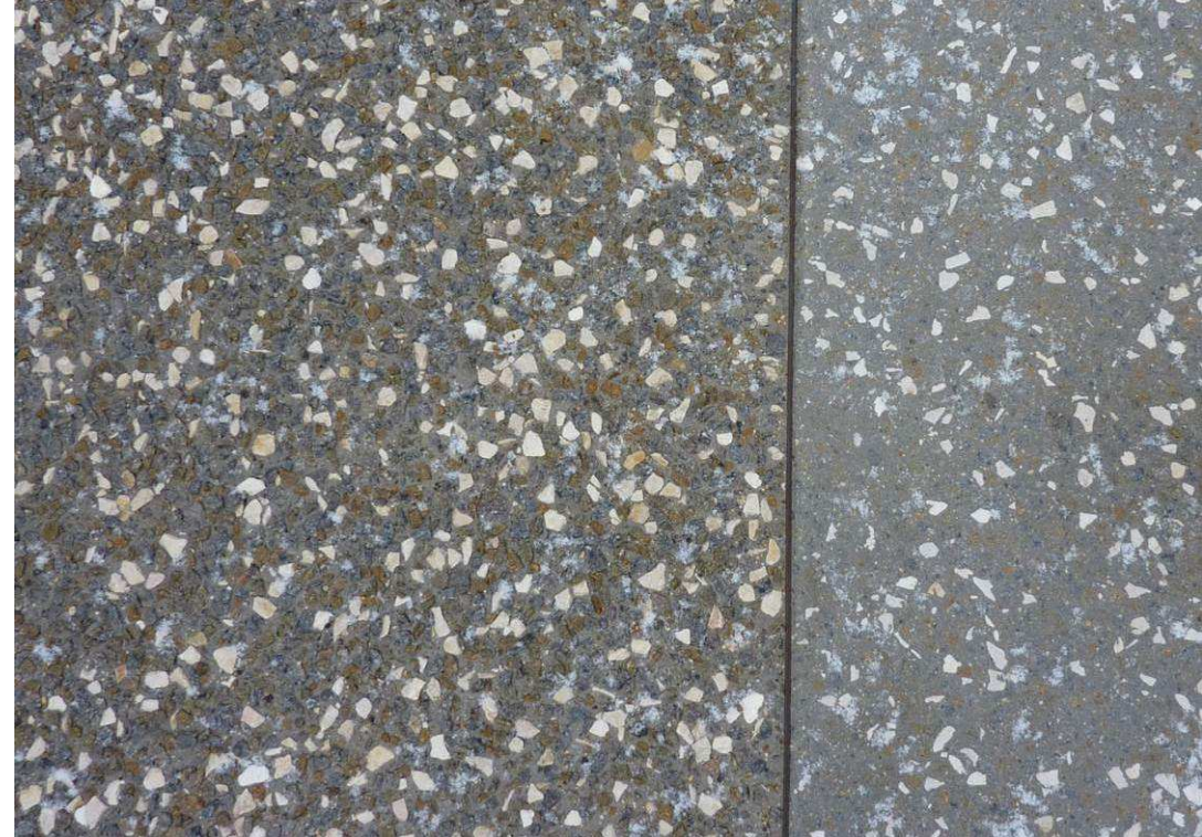
Béton avec incrustation de granulats ocre (finition sablé à gauche / finition poncé à droite)
