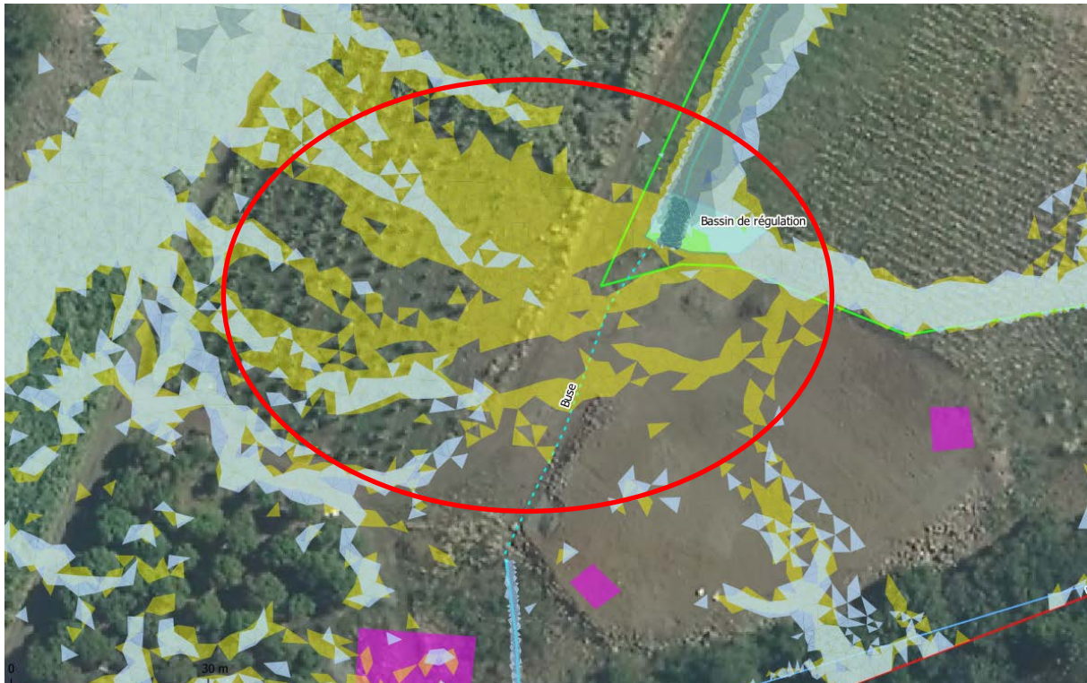
Figure 27 : Comparaison des emprises des écoulements à l'état projet sans mesure compensatoire hydraulique et à l'état projet avec mesures compensatoires hydrauliques
