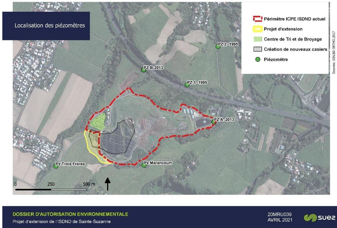
Figure 11 : Implantation des piézomètres de contrôle
