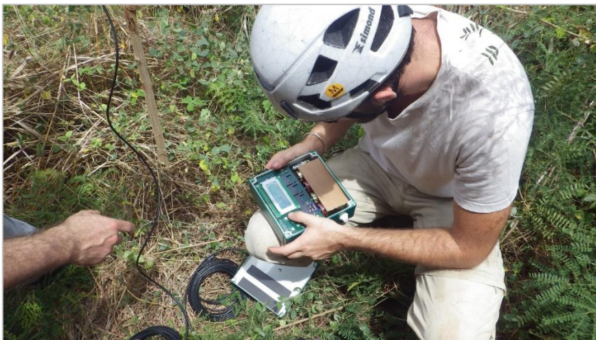
Figure 2. Pose d'un enregistreur acoustique SM2Bat+
