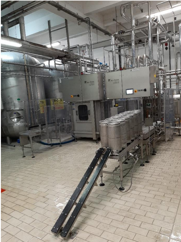
Ligne d’embouteillage des bières en fût - Brasserie
