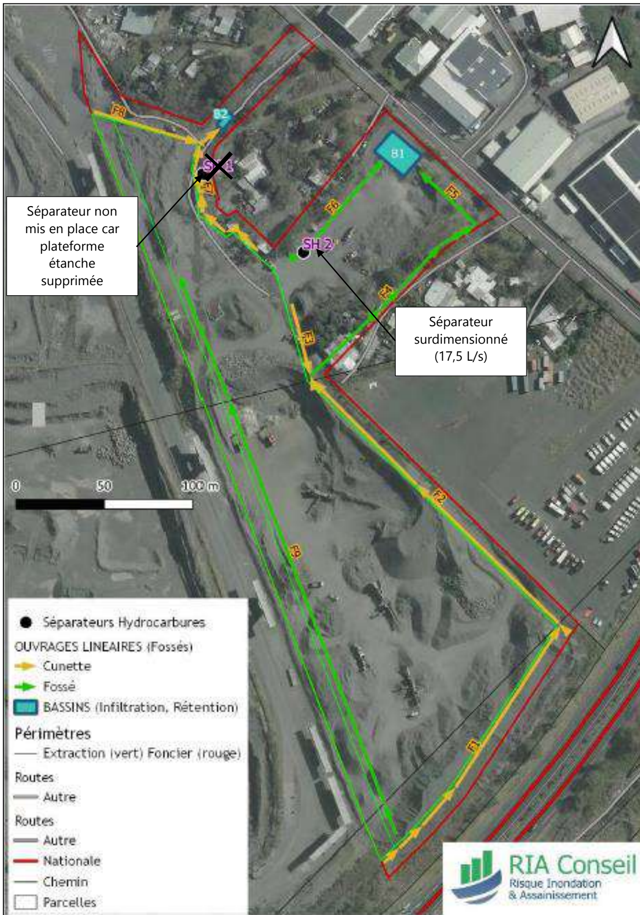
Planche 114 : Principe de la gestion des eaux de ruissellement sur le site de la carrière SETCR lors de l'exploitation
