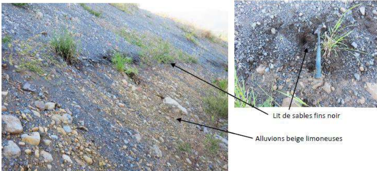
Planche 51 : Photographie d'une couche d'alluvions sablo-graveleuses beiges dans le talus au droit du sondage P2 (Source : Mascareignes Géologie)
