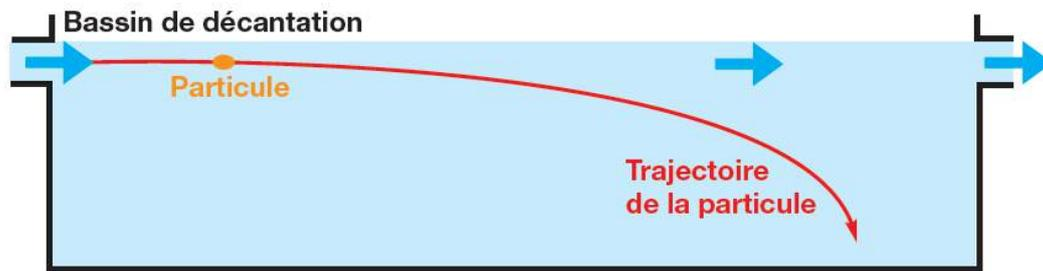
Figure 22 : Principe de décantation des particules (Guide EP Réunion, DEAL 2012)
