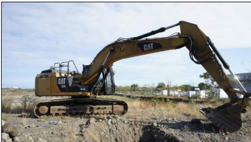
**Planche 19 : Pelle mécanique de 30 tonnes utilisée pour les sondages
