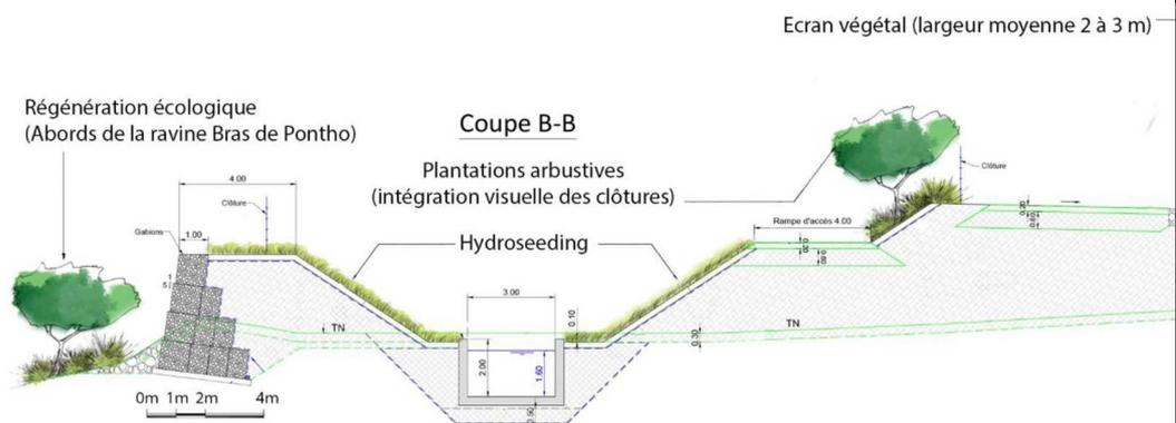
Figure 2 – Coupe B-B' illustrant les massifs boisés sur les merlons de protection et le long du chemin d'accès Est et du canal d'amenée (source : SODEXI Ingénierie)
