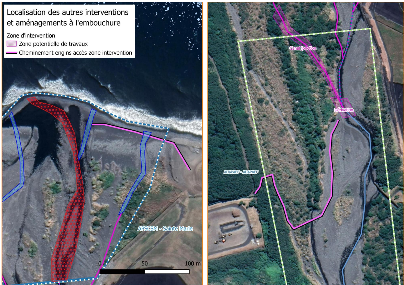
Figure 13 - Localisation des accès pour les engins (pelle à chenille) pour réaliser les travaux sur les canaux et sur la prise d'eau (le cas échéant) par l'APSCSM (Sainte Marie)
