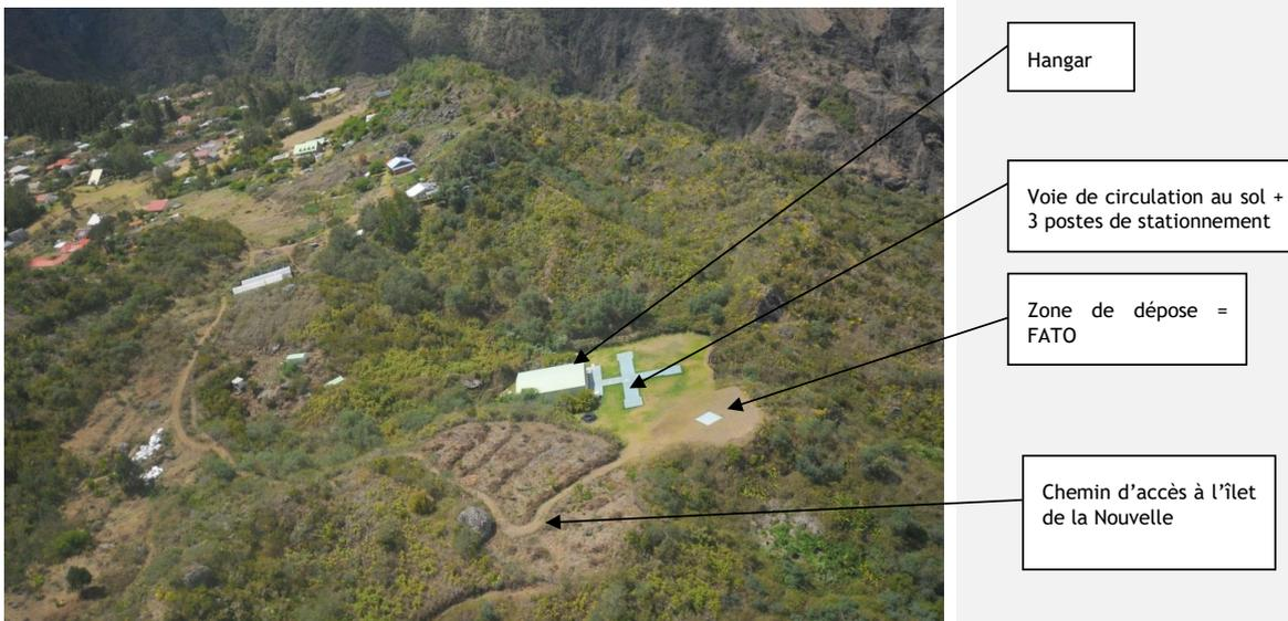
Photographie 5 : Hélistation de Mafate à la Nouvelle (ci-dessus : hélistation avec l'îlet de La Nouvelle / ci-après : vue rapprochée de l'hélistation). BIOTOPE, 2013.
